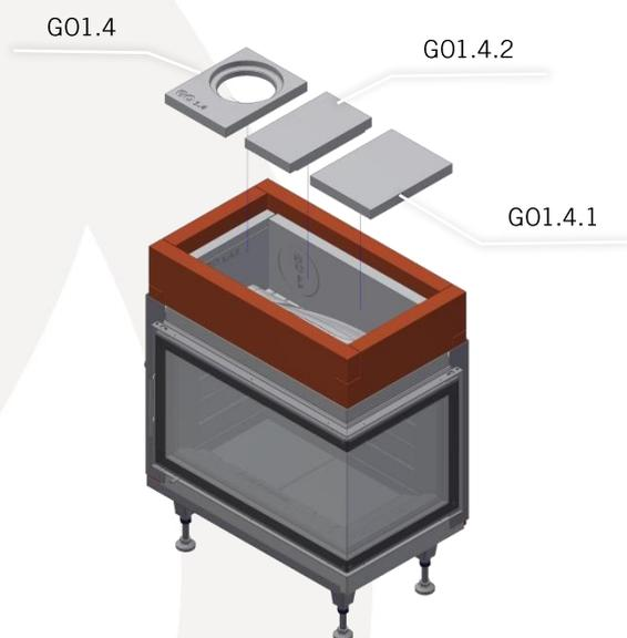
Positionieren Sie nun die Abdeckung der Nachbrennkammer.
