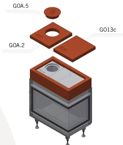
Verkleben Sie den Deckel des Mantels mit den Seitenteilen.
