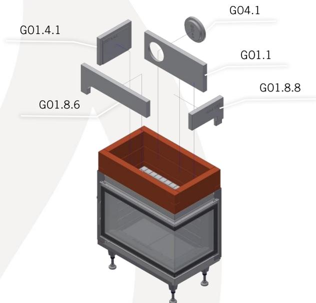
Versetzen Sie die Teile der Nachverbrennungskammer trocken. Bei nicht geschlossenen Fugen (abhängig von der Fugenstärke beim Aufbau der roten Mantelsteine) sind die Fugen mit Keramikfaser abzudichten. Die Nachverbrennung ist jedoch nicht untereinander zu Verkleben.
